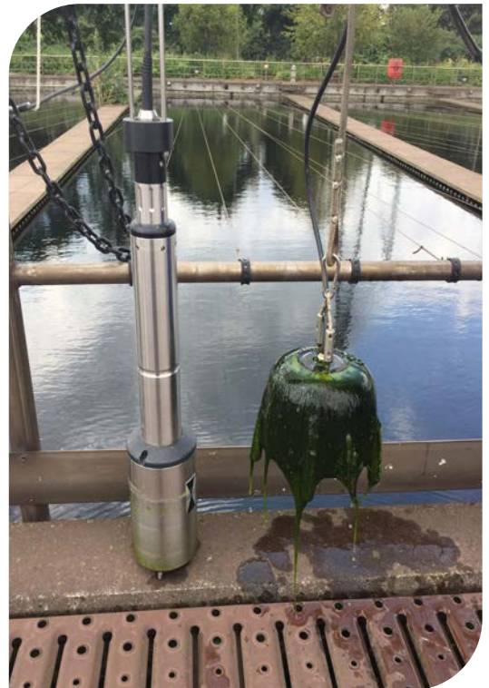
Abb. 1: Vergleich des Algenbewuchs auf IFL 700 IQ Sensor (links) und bisheriger Messtechnik (rechts) bei gleicher Betriebsdauer (ca. 4 Wochen)
